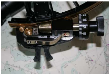
fig. 20 - nei sestanti Cassens & Plath il gruppo composto da nonio, vite senza fine e leve di sblocco è a vista
