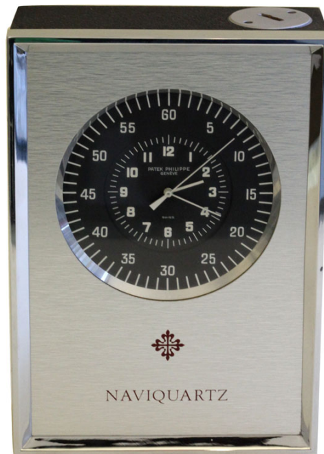
fig. 33 - I primi orologi Naviquartz con movimento al quarzo distribuiti da Patek Philippe ebbero diffusione a bordo delle navi alla fine degli anni '60. Trovavano generalmente alloggio in un vano ricavato nel tavolo da carteggio. La lettura veniva effettuata direttamente attraverso uno sportello munito di vetro che veniva aperto solo per controlli o sostituzione delle batterie. Fini imbottiture e pareti in legno pregiato proteggevano il cronometro da urti, vibrazioni e sbalzi di temperatura.
