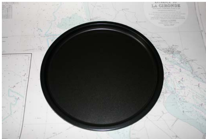
fig. 44 - la teglia utilizzata come orizzonte artificiale
