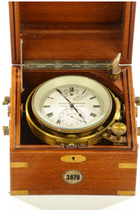
fig. 32 - Vecchio, ma prestigioso, cronometro di bordo. La carica veniva effettuata settimanalmente allo stesso giorno e possibilmente alla stessa ora da un ufficiale di coperta. L'incaricato aveva cura di ricaricare sempre l'orologio con gli stessi giri di chiavetta (visibile nell'angolo in alto a destra).
