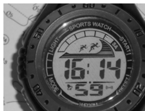
fig. 34 - Anche un orologio da polso (sempre custodito separatamente come un tradizionale cronometro marino) può sostituire un costoso cronometro, a patto che si tenga costantemente verificato il suo K.
