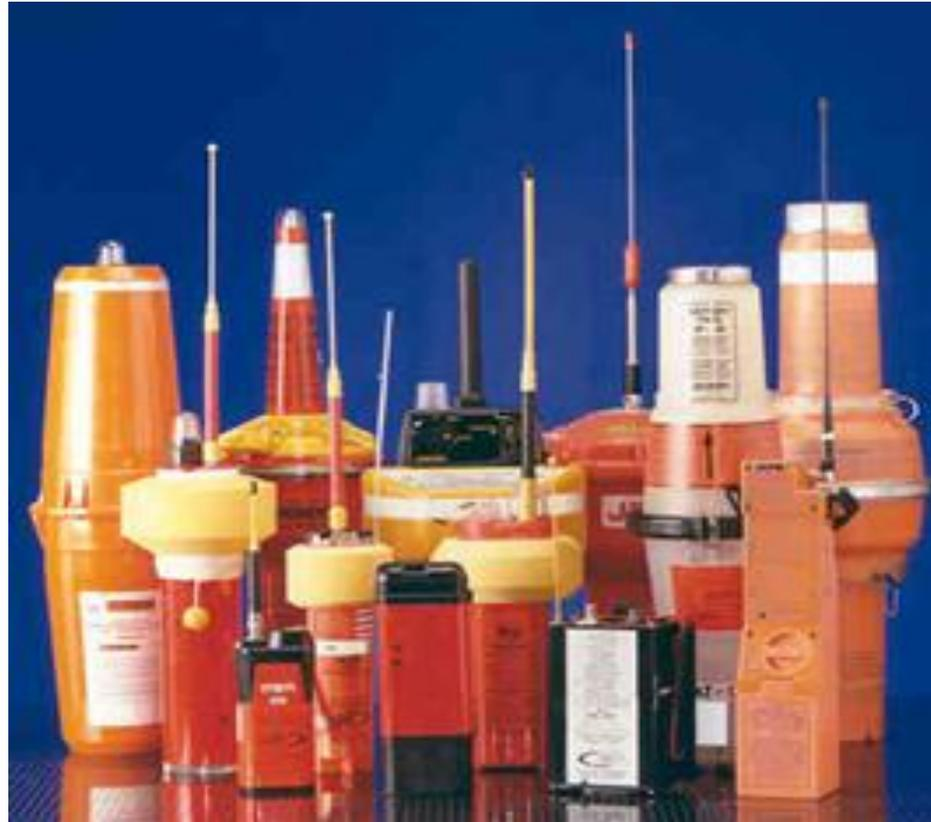
Alcun EPIRB possiedono anche una lampada LED lampeggiante ad alta luminosità per fornire un segnale visivo.
